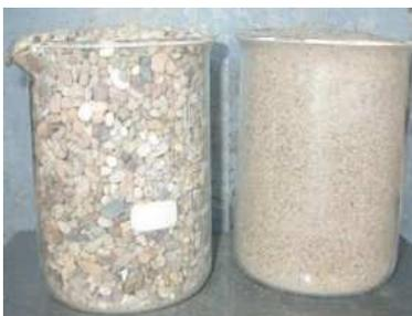
Metti i due aggregati di classe granulometrica diversa in due vasi separati e comprimili. Osservando i due vasi noterai bene gli interstizi presenti nell'aggregato di classe meno fine. Ciò induce a pensare che il tenore in spazi vuoti dell'aggregato più fine (a destra nella foto) sia inferiore rispetto a quello dell'aggregato più grosso (a sinistra nella foto).
