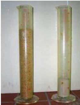
Vogliamo mescolare della malta con una proporzione di 1:4. Misuriamo in due recipienti graduati 800 ml di sabbia e 200 ml di cemento. Abbiamo così 1 000 ml (= 1 litro) di miscela asciutta.
