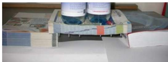
La situazione è molto diversa se l’elenco è fissato con le viti. Si vede chiaramente che l’armatura permette di compensare l’azione esercitata dalle forze di spinta. Anche se carichiamo l’elenco con due bottiglie di birra piene, esso praticamente non si piega.
